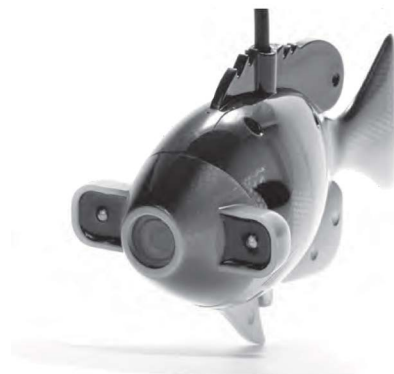
Замаскированная под рыбу камера с фонарями подсветки и кабелем
